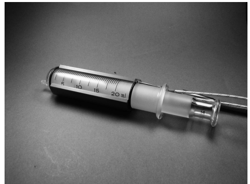
図2 金型内樹脂ガス計量システム【ガスゲージ】
