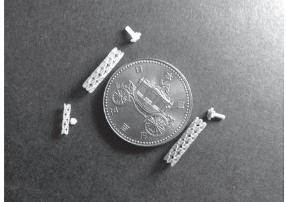
図2 生体用PEEK製(右)、PLA製(左上、左側面)のステント
